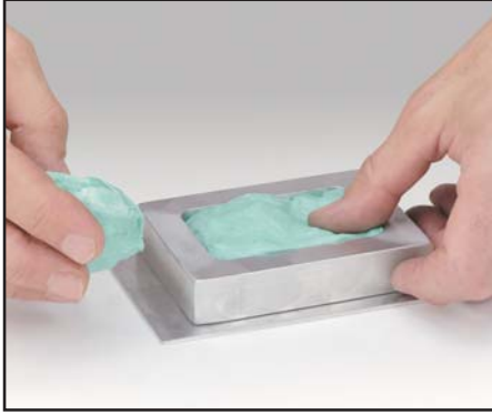
Kalıp, ısıtmaya ihtiyaç duymadan, soğuk preste sıkıştırılır.
