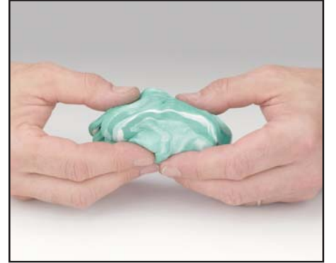
Hazırlanan kalıp 15 dakikada sertleşir.
